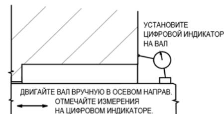
3. Определите перпендикулярность торца уплотнительной камеры по отношению к валу (0.001 мм на мм диам. вала, макс. ППИ) и concentricity вала по отношению к камере уплотнения.
