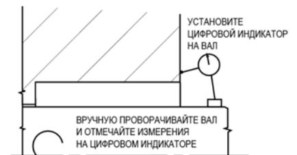
4. Измерьте биение вала/втулки (допускается 0.001 мм на мм. диам. вала по макс. ППИ)
